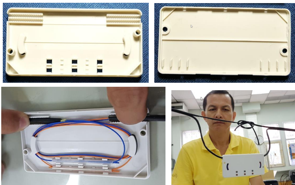
ภาพประกอบที่ 13. เชื่อมต่อสาย OFC Round Type 2F ด้วยผลิตภัณฑ์ต่อสาย OFC Flat Type
