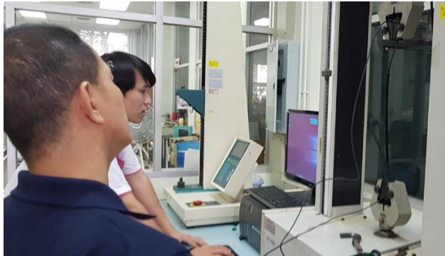
ภาพประกอบที่ 9. ทดสอบจุดเชื่อมต่อสาย OFC Round Type 2F ใช้ท่อ Protection Sleeve ร่วมกัน
