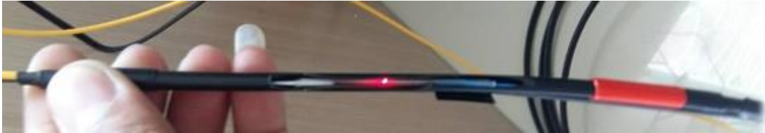
ภาพประกอบที่ 4. เหตุเสียในหลอดหุ้มจุดต่อสายจากอาการไหลของเส้นใยแก้วนำแสง
